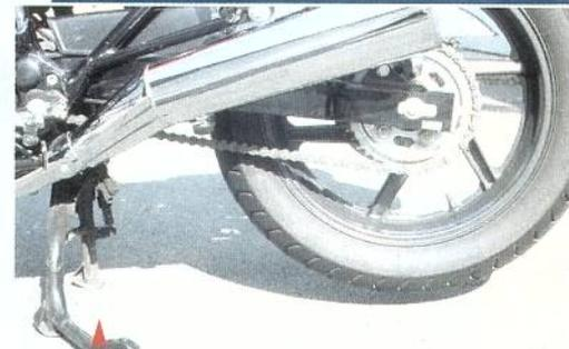
La tension et le graissage de chaîne s'effectuent sans problème, grâce à la présence de la béquille centrale.
