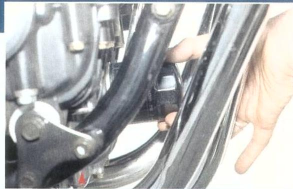
Malgré la proximité des tubes d'échappement, le filtre à huile est aisément manœuvrable.
